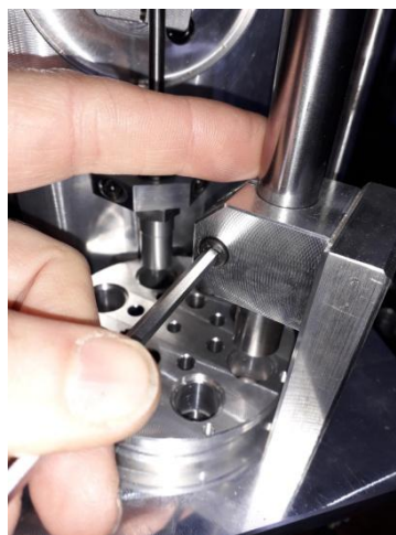
Montare il tubo di alimentazione bossoli alla corretta distanza
