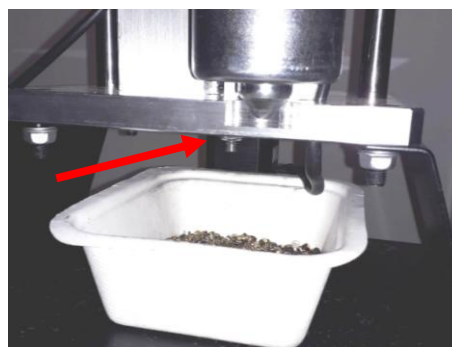
Uscita dei primer : lato posteriore sotto la base
